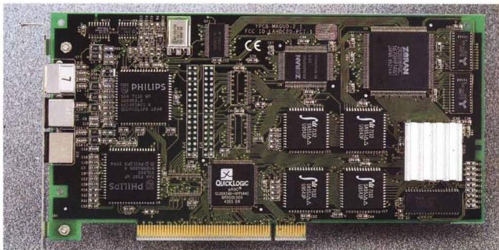
In primo piano l'ottima fattura della scheda, dotata di diversi chip dedicati: dai Philips per il trattamento video al codec MJPEG della Zoran.
